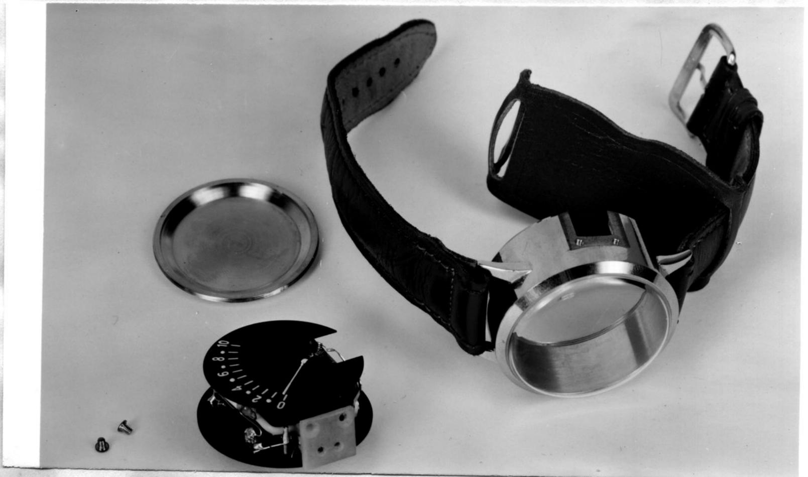
Abb. 15: Outputmeter - zerlegt
