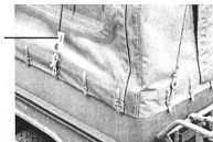
Figur 81 – EA Befestigung der Abspannseile
