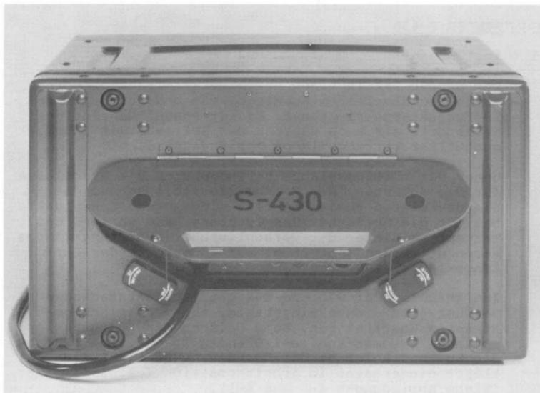
Abbildung 4-3: Ansicht Sender S-430 im Betriebszustand mit ausgestellter Lüftungsklappe
