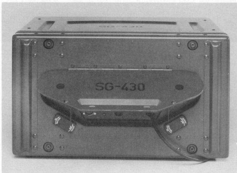
Abbildung 4-5: Ansicht Speisegerät SG-430 im Betriebszustand mit ausgesetzter Lüftungsklappe
