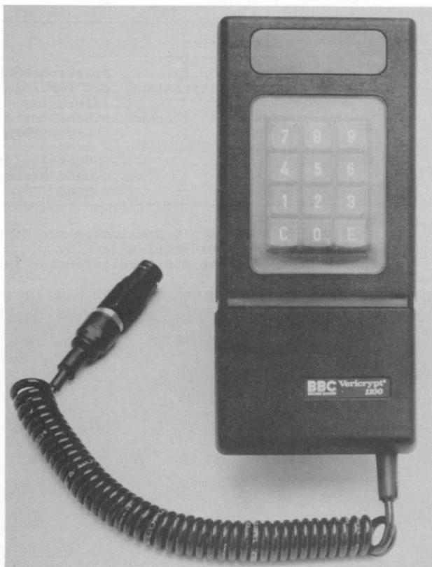
Figur A-5: Anschluss und Bedienelemente Schlüsselein-gabegerät
